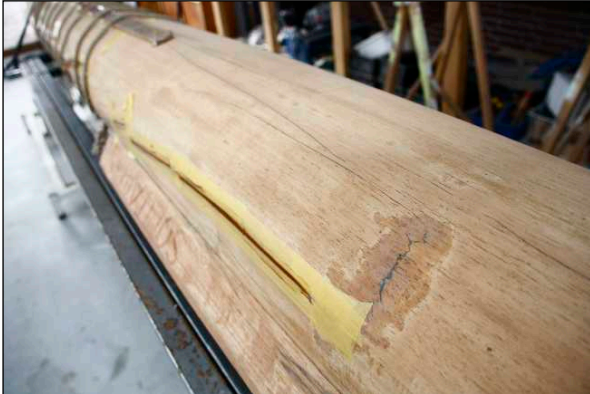
De Solitair II is nu helemaal kaal. Daardoor nu ook goed te zien reparaties uit het verleden.
