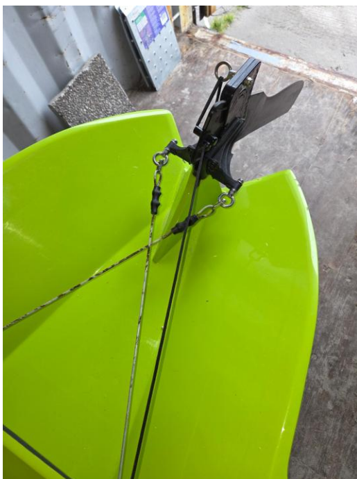
Foto 5.4 Twee stuurkabels (gekruid)
