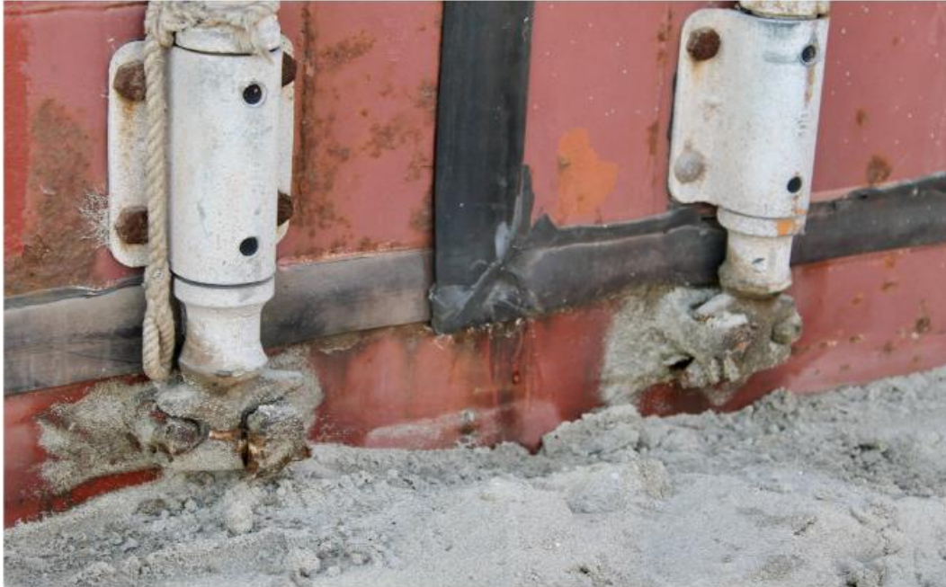
Foto 8.7 Het sluitingsmechanisme zit zowel aan de boven- als onderkant van de deur
