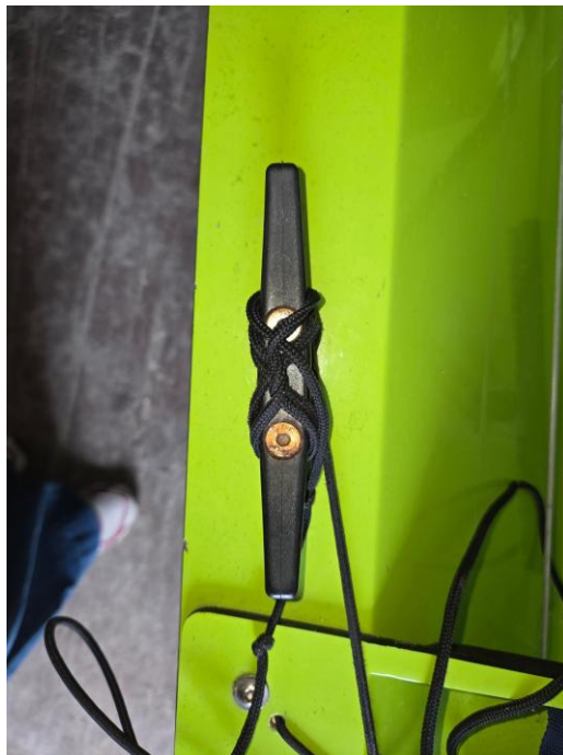
Foto 5.5 touwtje waarmee je de vin omhoog trekt en vast zet.
