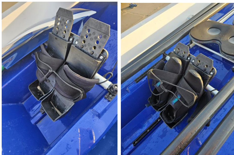
Foto 3.5 Voetenboord in de boten (rechts met waterschoenen erin)
