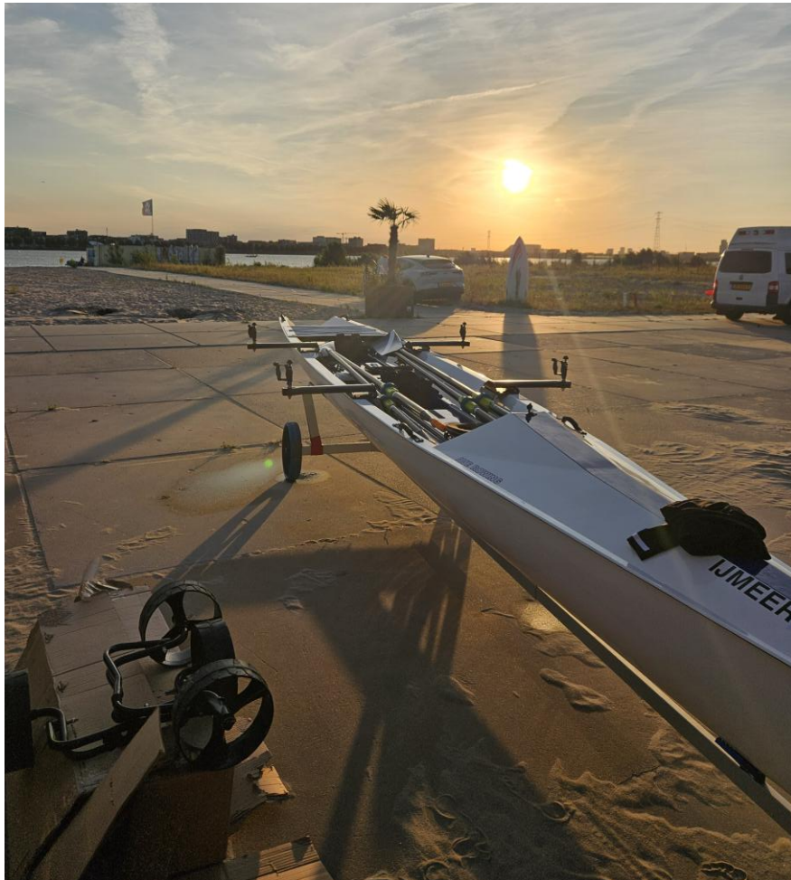
Foto 3.1 De coastalroeiboot is breder, met kortere riggers.
