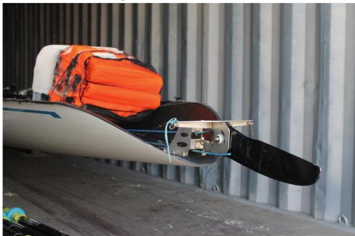
Foto 4.1 Zijn de reddingsvesten aanwezig en is het roer omhoog geklapt?
