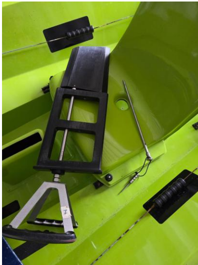
Foto 5.1 De vin van de Sapo met de vastzet pin ernaast
