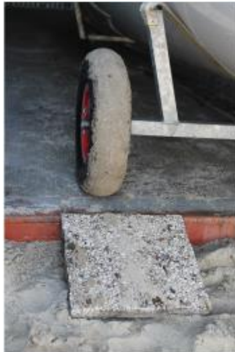
Figuur 28: Leg tegels of planken neer in de containeropening zodat de trailer daar overheen naar buiten kan rijden
