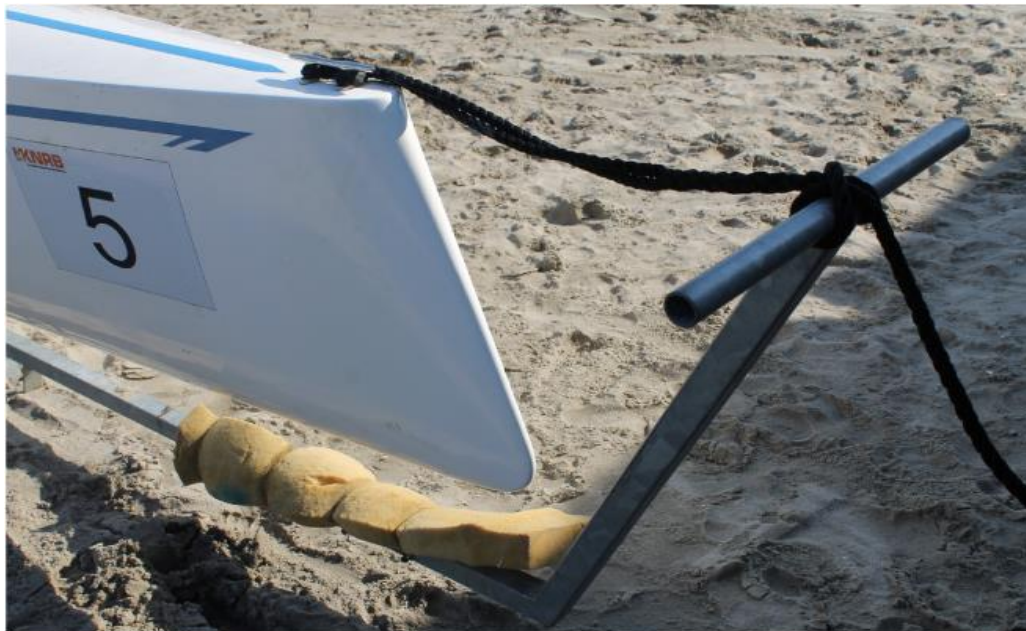
Figuur 15: Zit de boot met de landvast vast aan de trailer?
